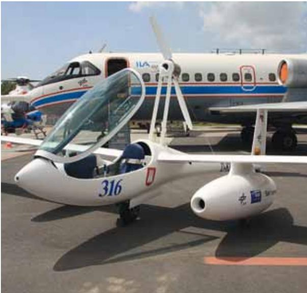
Eine Lange Antares 20E des DLR, in der die elektrische Energie mittels Wasserstoff über eine Brennstoffzelle erzeugt wird Foto: Wo st 01
